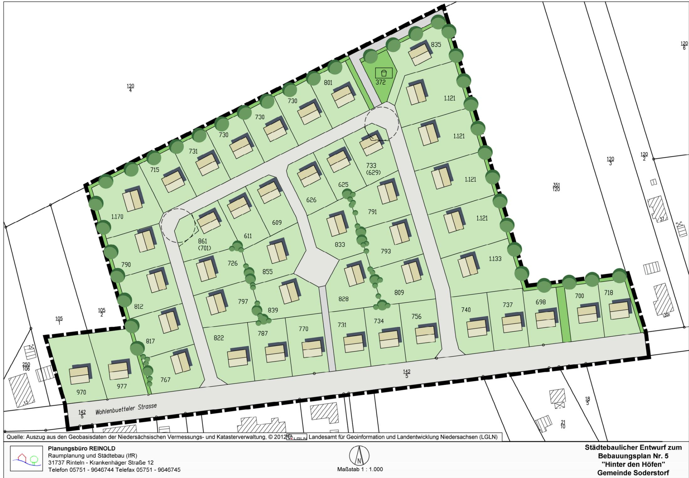
**Anlage 4: Bildung von Bauabschnitten: hier ein möglicher erster Abschnitt**
